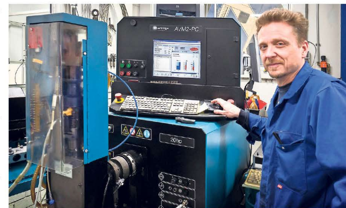
Walter Jandl bij de testbank van inspuittinstallaties.
